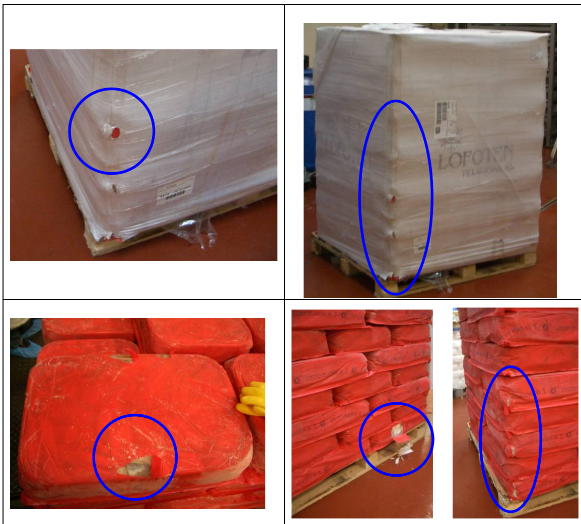
Figur 11: Typiske skader som ble observert hos mottakerbedrift i Nederland.
